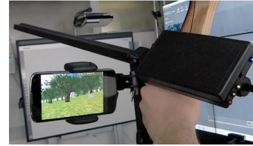
Şekil 2. Mobil cihazlar entegrasyonlu okçuluk similatörü (Drochtert vd., 2013)
